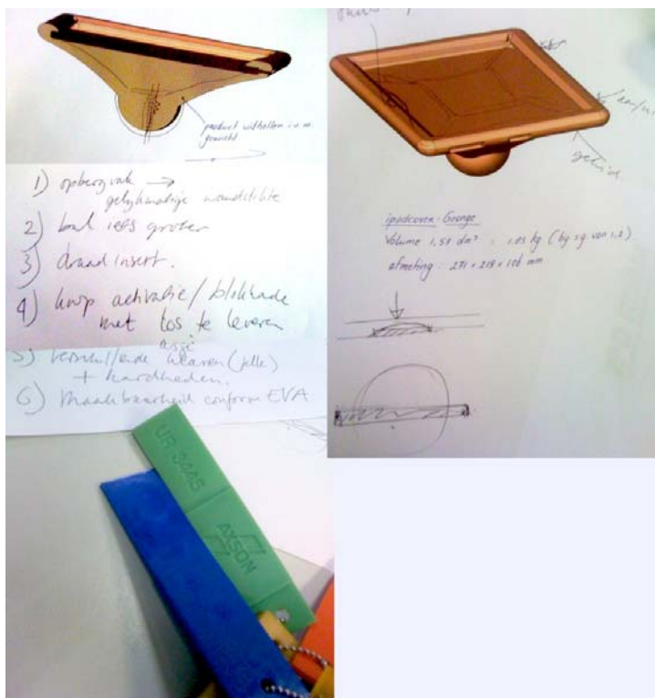
Figuur 3: Notities voor aanpassing ontwerp uit eerste fase
